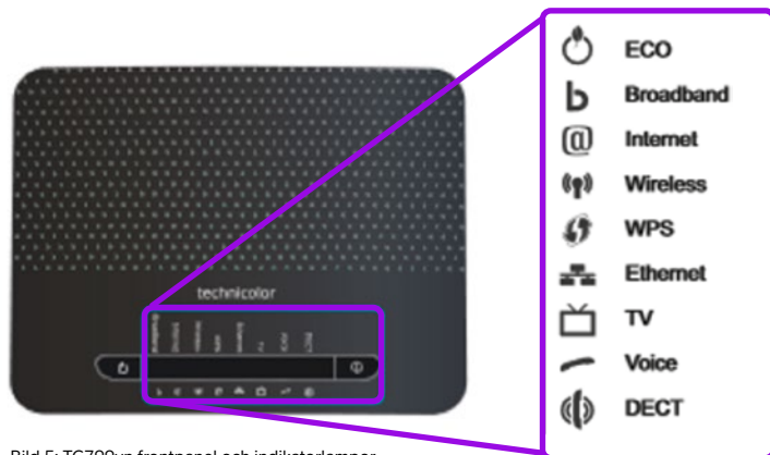
Bild 5: TG799vn frontpanel och indikatorlampor
