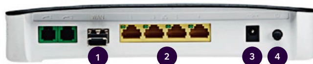
Bild 9: TG1100 bakre panel och kopplingar
