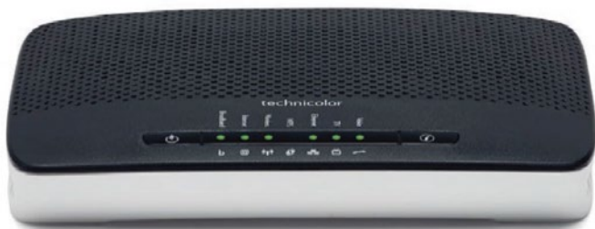
Bild 8: TG1100 frontpanel och indikatorlampor
