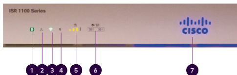
Kuva 4. C1111-8PLTEW -reitittimen merkivalot edessä
